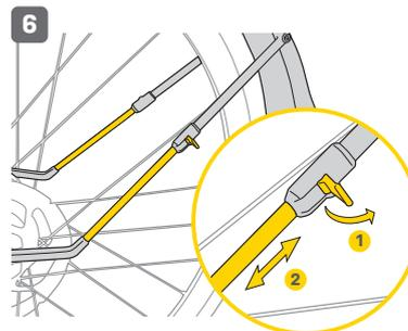
Öffnen Sie die Klemmverschlüsse und stellen Sie die Länge der Montagestreben auf beiden Seiten passend für Ihr Fahrrad ein.
