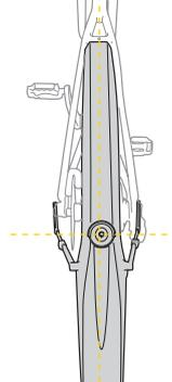
Stellen Sie sicher, dass das Schutzblech korrekt auf den Reifen ausgerichtet ist. Ziehen Sie alle Schrauben nach der korrekten Montage mit dem empfohlenen Drehmoment an.
