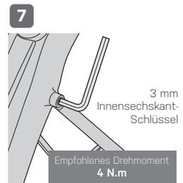
Ziehen Sie alle Schrauben nach der korrekten Montage mit dem empfohlenen Drehmoment an.
