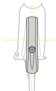
Stellen Sie sicher, dass das Schutzblech korrekt auf den Reifen ausgerichtet ist. Ziehen Sie alle Schrauben nach der korrekten Montage mit dem empfohlenen Drehmoment an.
