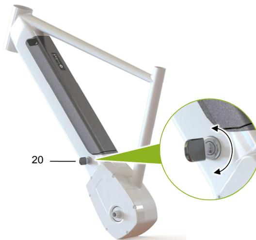
Die unterschiedlichen Montagevarianten des Akkus bedingen auch verschiedene Varianten der Akku-Sicherung. Detaillierte Informationen zur Ver- und Entriegelung des Akkus erhalten Sie von Ihrem Fahrradhändler oder Fahrradhersteller.
